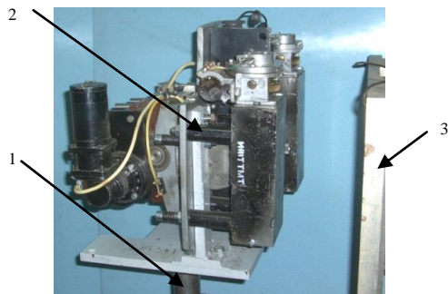
Рис. 10. Діюча модель модуля: 1 – штанга стенда з кріпильним фланцем; 2 – модуль; 3 – зразкова металева плита
