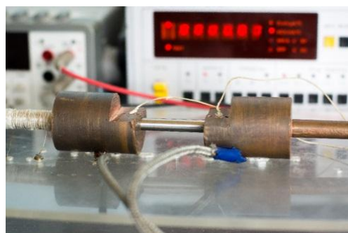
Рис. 1. Схематическое представление методики (а) и внешний вид устройства (б) для измерения термоЭДС. Блоки А и В – медные
