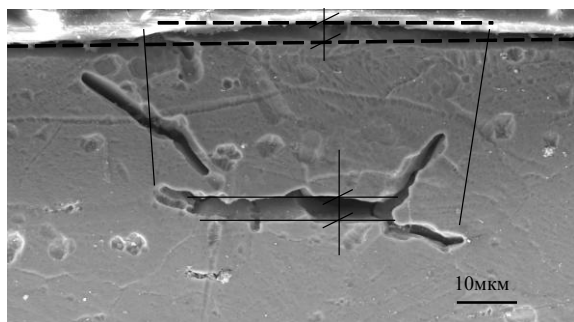
Рис. 6. Вздутие на поверхности и трещина под ним
