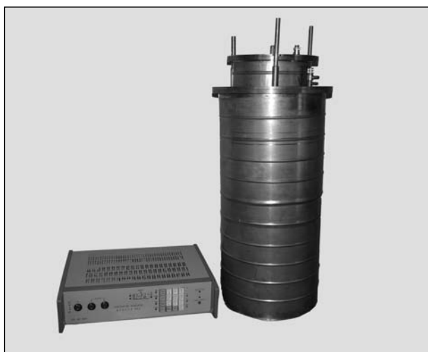
Рис. 4. Загальний вигляд терморегульованого азотного кріостата
