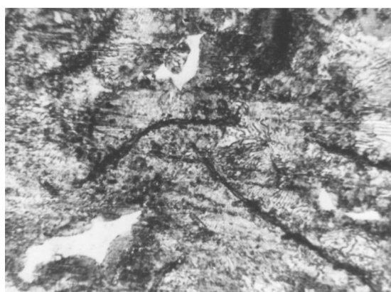
Рис. 10. Микроструктура чугуна, содержащего (% по массе): 1,65 С; 20,6 Cr; 9,3 Al, травлено 2%-ным ниталем, \times 600
