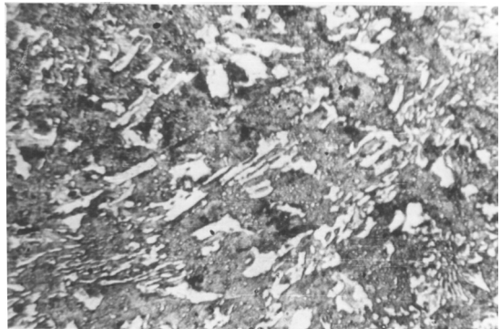
Рис. 6. Микроструктура чугуна, содержащего (% по массе): 2,7 С; 10,2 Cr; 0,23 Al, травлено 2%-ным ниталем, \times 360
