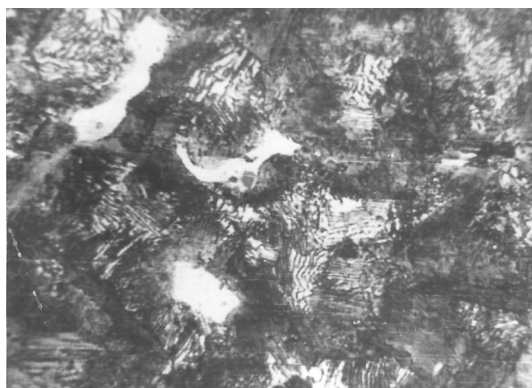
Рис. 9. Микроструктура чугуна, содержащего (% по массе): 2,04 С; 20,6 Cr; 6,73 Al, травлено 2%-ным ниталем, \times 600
