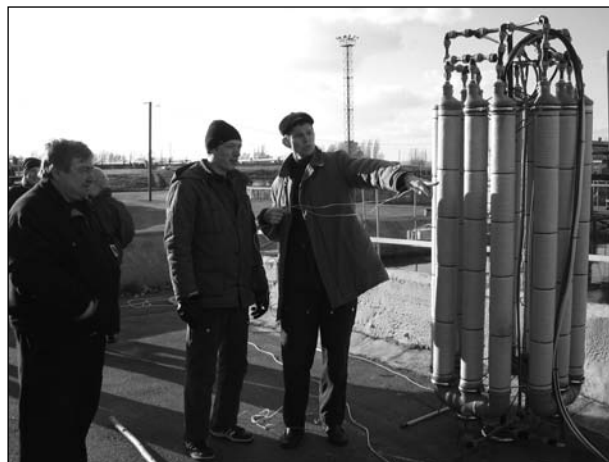
Рис. 2. Фото фільтрувального модуля пілотної установки
