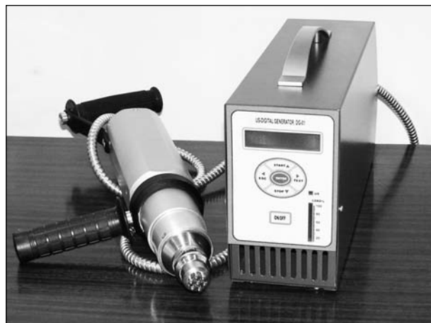
Рис. 2. Цифровий ультразвуковий генератор з віброударним інструментом
