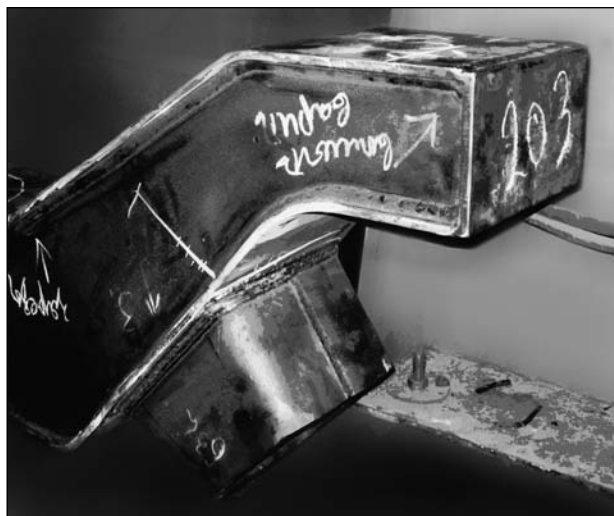
Рис. 3. Місце приварювання кронштейна важеля до нижнього листа
