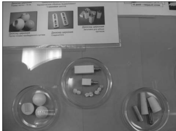
Розробка Донецького фізико-технічного інституту ім. О.О. Галкіна НАН України «Нанопорошки на основі діоксиду цирконію та технологія їх отримання»
