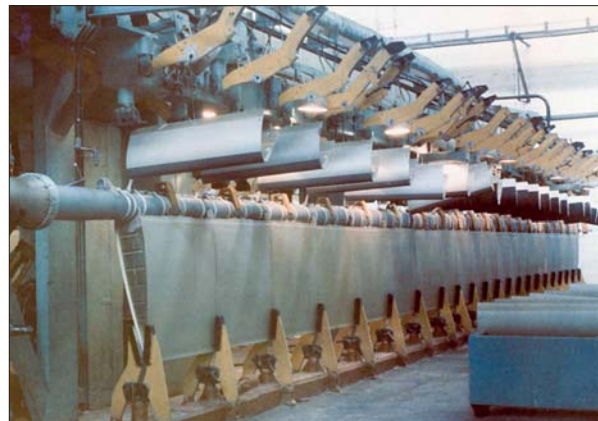
Рис. 4. Стapelь збирання прямокутної лопати із суцільнолягнутих лонжеронів після швидкісної електротермічної обробки
