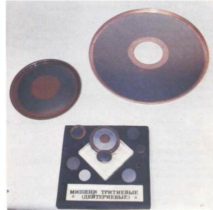
Рис. 1. Мішені, що містять тритій для нейтронних генераторів
