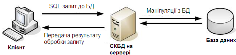
Рис. 3. Схема організації роботи з базою даних у розробленій системі моделювання з клієнт-серверною архітектурою
