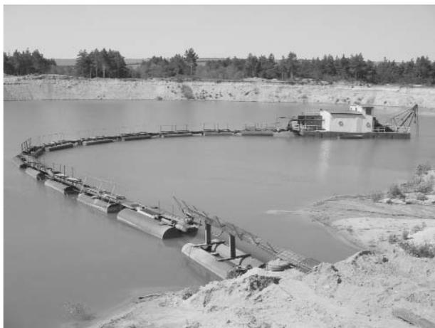
**Рис. 2.** Применение земснаряда при разработке песка в обводненном карьере
