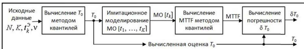
Рис. 1. Схема комплексирования для оценки погрешности  $\delta T_0$
