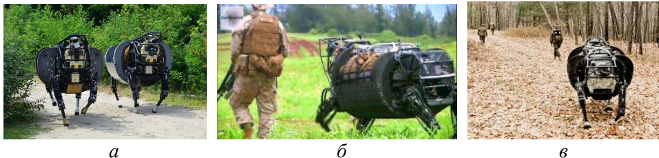
Рис. 1. Роботы-мулы фирмы Boston Dynamics: а) несущие тяжелую поклажу; б) сопровождающие солдат; в) движущиеся по пересеченной местности
