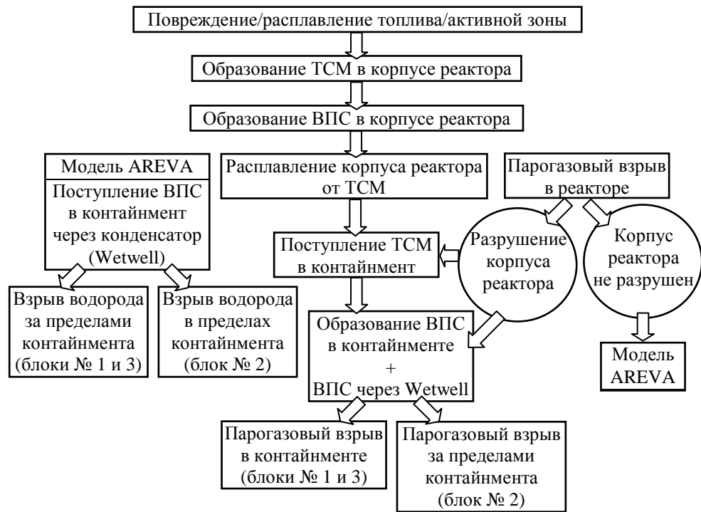
Рис. 5. Обобщенная модель гипотетических последовательностей развития тяжелых аварий на блоках № 1 –3 АЭС Fukushima-Daiichi (ВПС – водородо-парогазовая смесь).
