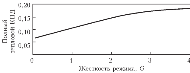
Рис. 1. Влияние жесткости режима на полный тепловой КПД [15]
