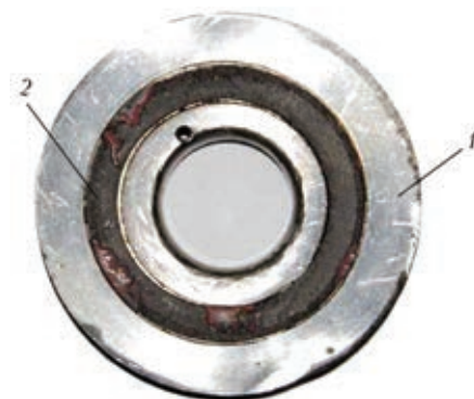
Рис. 1. Поверхность разрушения соединения металла (1) с графитом (2)
