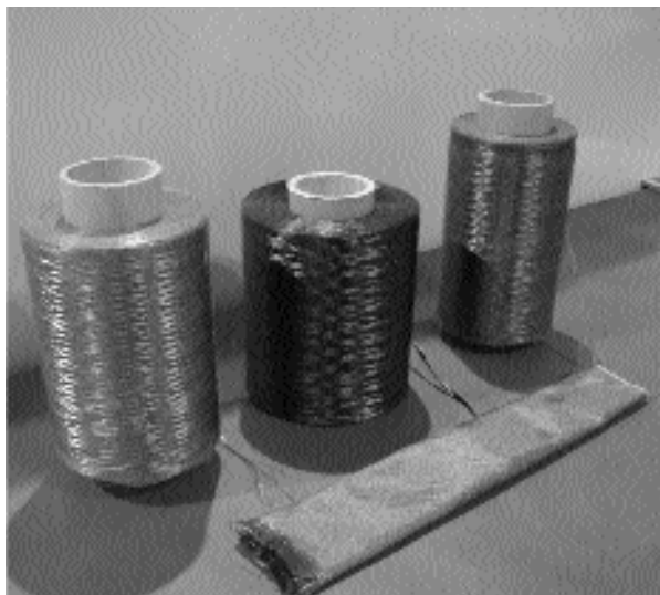
Рис. 4. Базальтові неперервні волокна виготовлені із гірських порід різних регіонів світу
