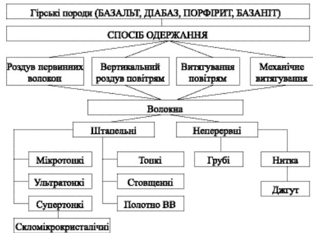
Рис. 1. Принципова схема виготовлення базальтових волокон та їх асортимент
