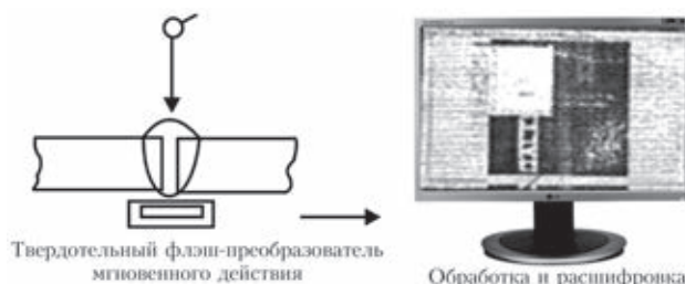
Рис. 3. Схема просвечивания без промежуточных носителей информации
