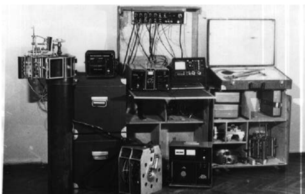
Рис. 9. Переносна установка контролю якості згинчування різбових з'єднань УКС-1
