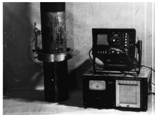
Рис. 10. Переносна установка контролю герметичності різбових з'єднань обсадних труб Контакт-1
