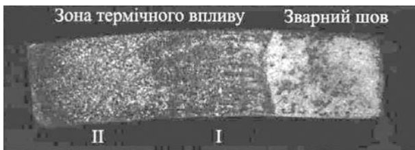
Рис. 3. Макробудова зварного з'єднання (поздовжній шліф)
