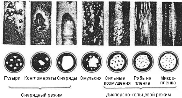
Рис. 3. Основные режимы течения двухфазного парожидкостного потока в цилиндрическом ПК.
