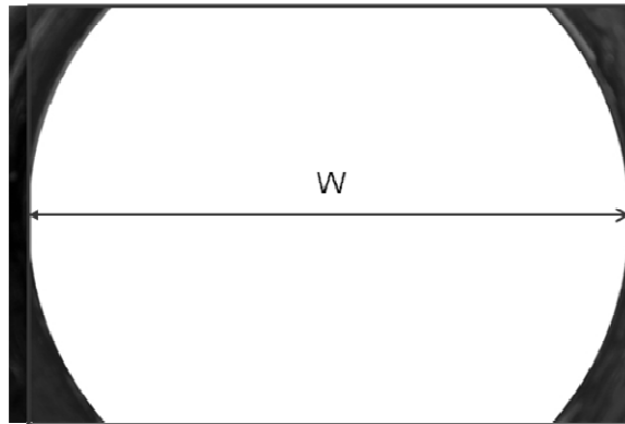
Рис. 5. Калибровочное изображение для определения реального размера пикселя.
