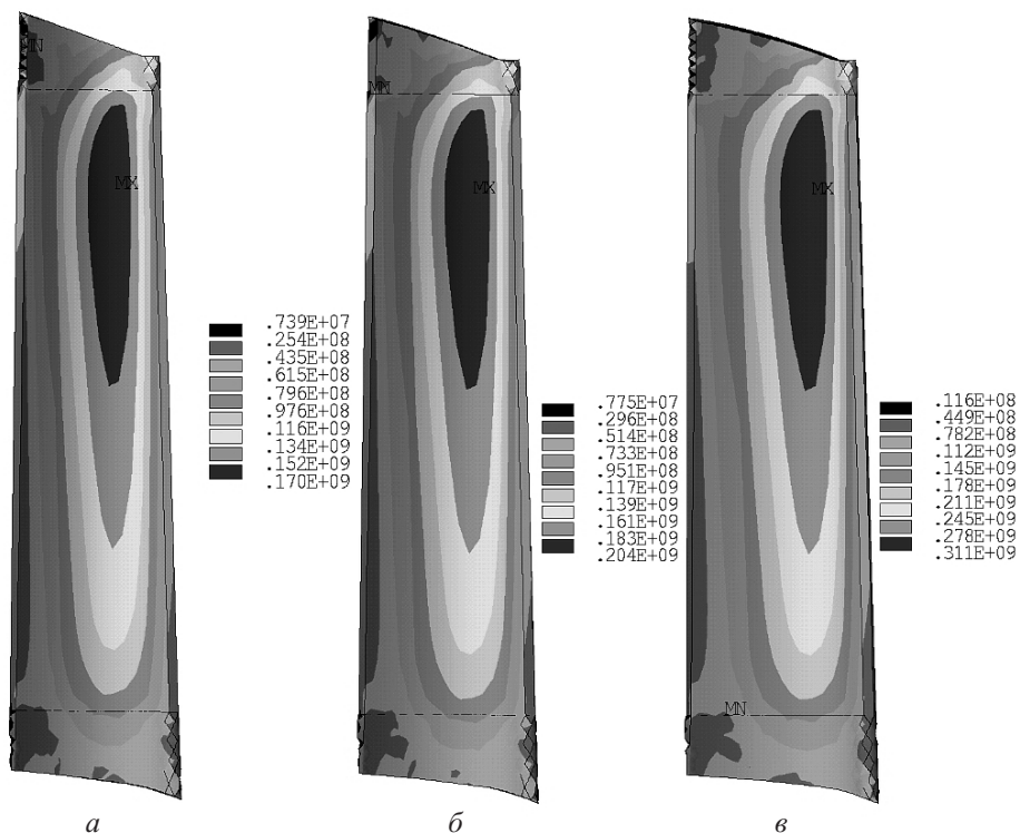
Рис. 6. Распределение интенсивности напряжений в перо лопатки при \alpha = 50 (а), 55 (б) и 65^\circ (в).
