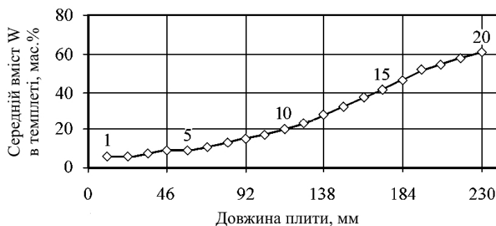
Рис. 1. Середній вміст вольфраму в КМ Cu–W уздовж довжини плити.
