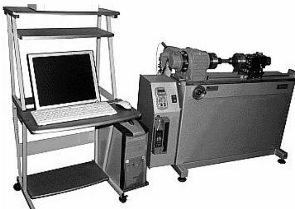
Рис. 1. Внешний вид установки ТТМ-200 для проведения испытаний на кручение.
