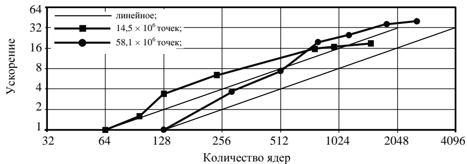
Рис. 2. Ускорение в модели Мирового океана в зависимости от числа используемых вычислительных ядер. Показаны графики для модели с разрешением 0,25^\circ ( 14,5 \times 10^6 точек) и 0,125^\circ ( 58,1 \times 10^6 точек).
