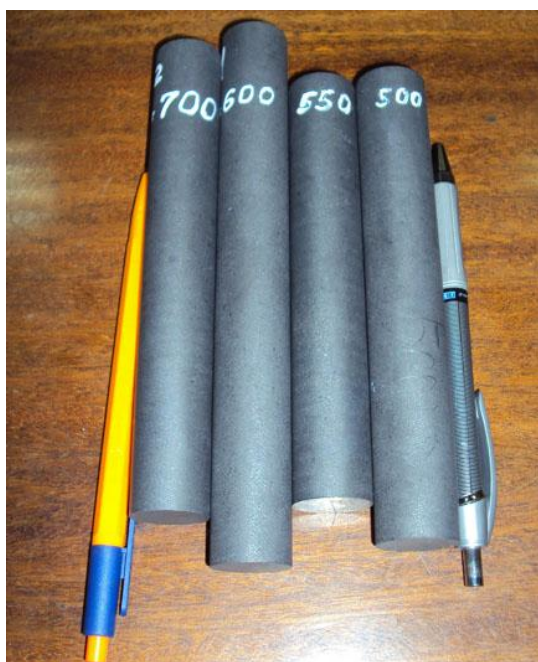
Рис. 4. Внешний вид образцов, уплотненных с использованием пропан-бутановой смеси при температурах 700, 600, 550 и 500 °С соответственно (слева направо)
