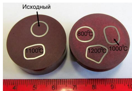
Рис. 5. Общий вид кольцевых образцов Zr-1%Nb после деформации при разных температурах перегрева
