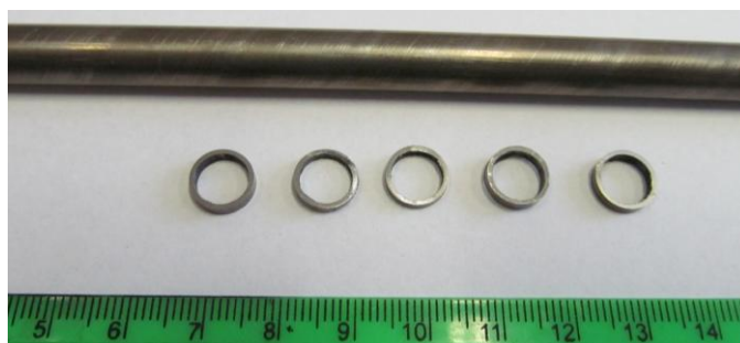
Рис. 1. Фрагмент твэльной трубки из сплава Zr-1%Nb и вырезанные из нее кольца
