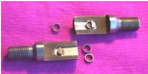
Рис. 1. Внешний вид кольцевого образца и приспособления для испытаний
