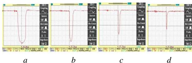
Fig. 17. Pulse duration of beam current for time shift  $\tau$ :  $\tau=0$   $\mu\text{s}$  (a);  $\tau=1.0$   $\mu\text{s}$  (b);  $\tau=1.5$   $\mu\text{s}$  (c);  $\tau=1.9$   $\mu\text{s}$  (d)
