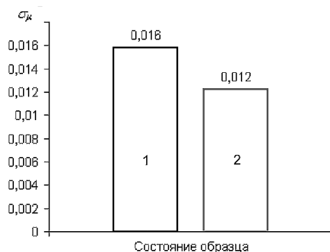
Рис. 7. Изменение относительной величины \sigma_\mu для образца в зависимости от его состояния: 1 – исходное; 2 – после обработки ИЭТ.
