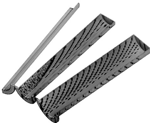
Рис. 6. Расчетная картина интенсивности напряжений в трубах ( t = 800 мкс).
