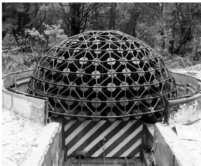
Рис. 1. Общий вид трубчатой камеры для сварки взрывом.
