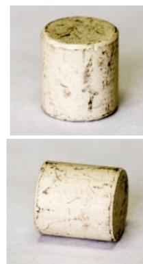
Рис. 1. Результаты коррозионных испытаний таблеток гафната диспрозия в водном теплоносителе при температуре 350 °С и давлении 16,8 МПа: а – зависимость привесов образцов от времени испытаний, имеющих разную пористость: 1 – 3,7...4,9; 2 – 6,5...7,5; 3 – 14...16%; б – внешний вид таблеток после коррозионных испытаний длительностью 7200 ч
