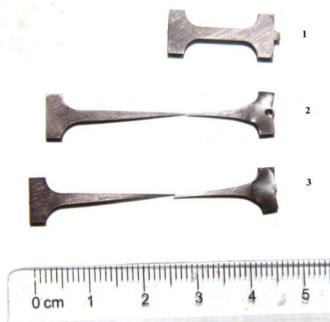
Рис. 1. Исходный образец для механических испытаний на растяжение (1) и образцы после механических испытаний при 675 К и различных скоростях (2 – \dot{\varepsilon} = 9,26 \cdot 10^{-3} \text{ c}^{-1} , \varepsilon = 278\% ; 3 – \dot{\varepsilon} = 6,3 \cdot 10^{-4} \text{ c}^{-1} , \varepsilon = 348\% )
