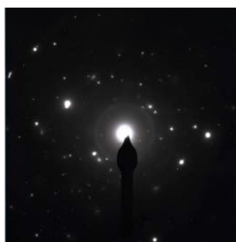
Рис. 2. Дифракция от карбида типа Fe_7C_3
