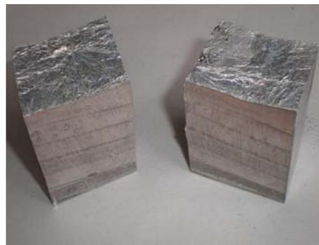
Рис. 1. Общий вид брусков магния до помещения их в тигель для сублимации
