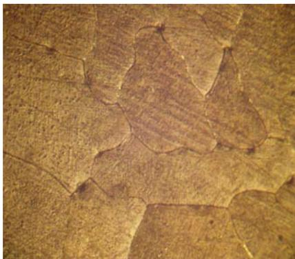
Рис. 8. Микроструктура вихідного зразка магнію
