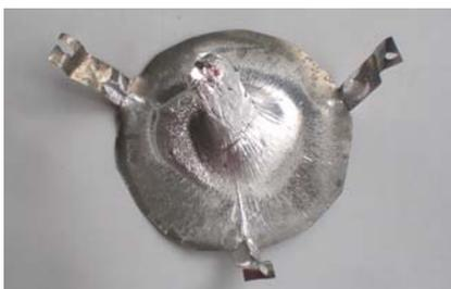
Рис. 6. Монокристалл магния, выросший на круглой перегородке колонки
