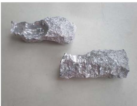
Рис. 2. Общий вид брусьев магния после проведения процесса сублимации
