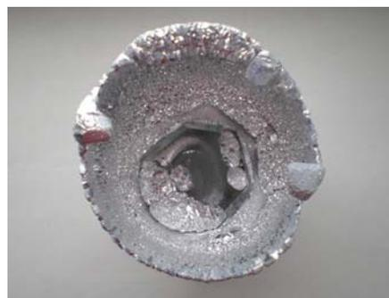
Рис. 5. Вид дистиллята магния со стороны фильтра (тигля)
