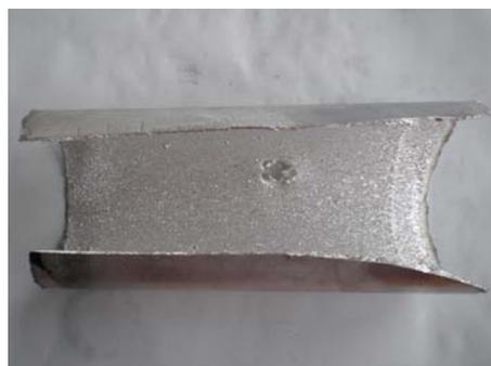
Рис. 4. Общий вид разворота гладкой колонки после сублимации магния
