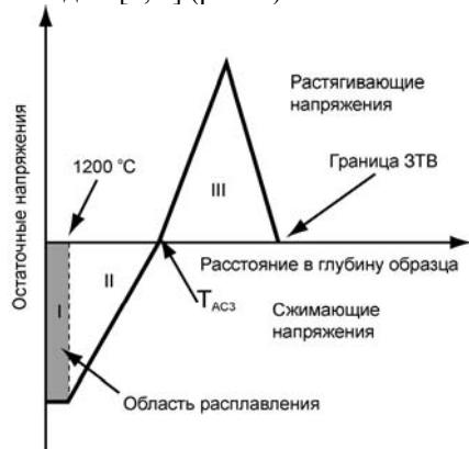
Рис. 5. Характер распределения напряжений в глубь материала при частичном расплавлении поверхности
