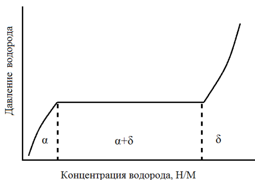
Рис. 11. Схематическое представление изотермы давление–состав. По достижении предела растворимости в \alpha -фазе начинается образование гидридов из пересыщенного твердого раствора \alpha -фазы [57]
