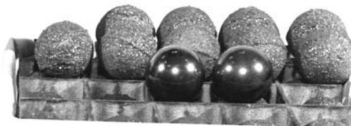
*Рис. 2. Внешний вид шаровых твэлов, изготовленных с использованием технологии производства графита ГСП*
