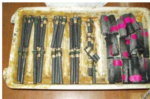
*Рис. 3. Внешний вид заготовок и элементов пэлов из карбида бора на пироуглеродной связке*
