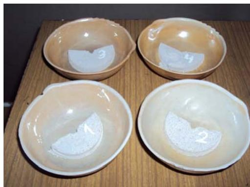
Рис. 9. Внешний вид золы, оставшейся после выжигания пироуглеродной матрицы на воздухе при 900 °С
