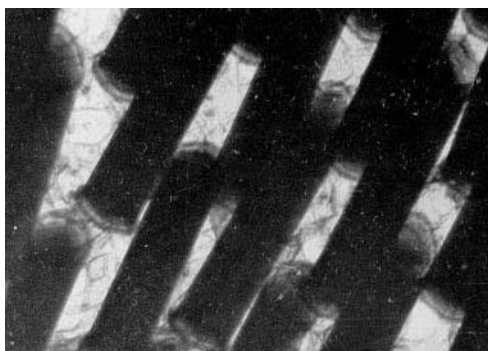
Рис.2. Однородная (регулярная) микроструктура эвтектических сплавов: а – Nb-Nb 2 C, продольное сечение, R = 120 мм/ч ; б – Ta-Ta 2 C, поперечное сечение, R = 15 мм/ч, G = 300 К/см, ув.10000; в – Ta-Ta 2 C, поперечное сечение, R = 200 мм/ч, ув.6500
