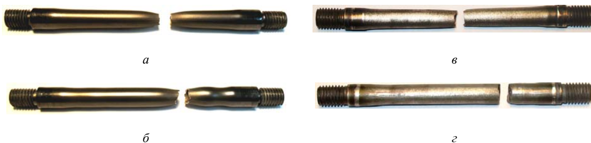
Рис. 5. Характер деформации и разрушения макетов пэлов с оболочками из сплава Э110 после нагрева в среде водяного пара при температурах: а - 800 °С (без V_4C ); б - 800 °С (с V_4C ); в - 1200 °С (без V_4C ); г - 1200 °С (с V_4C )
