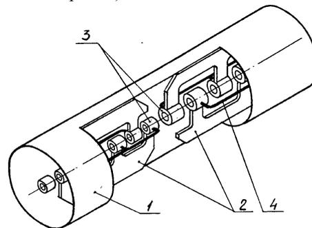
Рис. 1. Ускоряющая структура: 1–корпус, 2–подвески трубок дрейфа, 3– трубки дрейфа, 4–стабилизирующие петли
