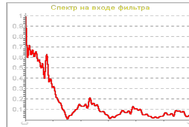
Рис.9. Нормированный амплитудный спектр ФКМ сигнала (код Баркера)
