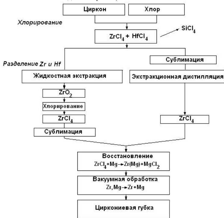
Рис. 1. Технологические схемы производства циркониевой губки в западных странах [8]
