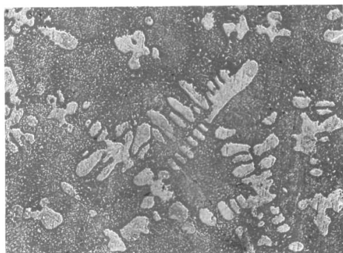
Рис. 5. Микроструктура железоскандиевой лигатуры, \times 200
