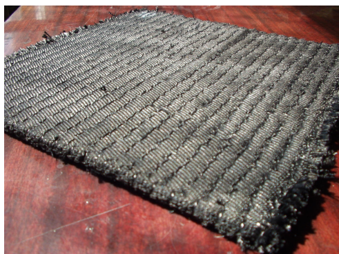
Рис. 1. Внешний вид преформы
