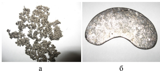
Рис. 3. Внешний вид веществ после восстановления: а - железо; б - свинец
