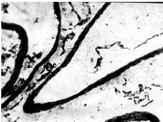
Рис.7. Ультратонкая структура моркови после вакуумной сушки при T=40\text{ }^{\circ}\text{C} ( \times 12000 )
