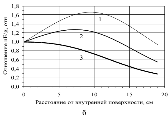
Рис. 2. Изменение плотности потока нейтронов (а) и отношения плотности потока нейтронов к радиационному энерговыделению (б); нейтронов с энергией: 1 – 0,1 < E < 0,5 МэВ; 2 – E > 0,5 МэВ; 3 – E > 3,0 МэВ; 4 – радиационное энерговыделение (а); нейтронов с энергией: 1 – E > 0,5 МэВ; 2 – E > 1,0 МэВ; 3 – E > 3,0 МэВ [11](б)
