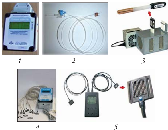
Рис. 9. Термоелектрична медична апаратура: прилад для вимірювання температури крові у судинах (1) та всередині ока (2); прилади для лікування захворювань шкіри (3); діагностики онкозахворювань молочної залози (4); діагностики хребцевих запальних процесів (5)
